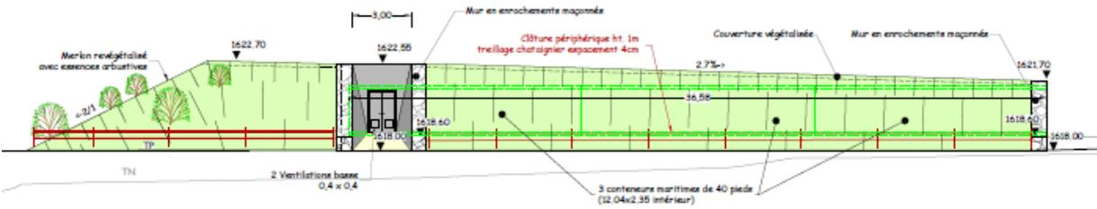
Vinci est missioné pour les opérations de terrassement et de mise en place de l'ouvrage. Coprem propose une galerie constituée de cadres 250\*250 avec l'adaptation des issues par des prédispositions d'aciers en attente.
